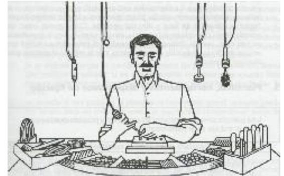
3.- Deben utilizarse depósitos y medios de «abastecimiento por gravedad», para que el material llegue tan cerca como sea posible del punto de utilización.
